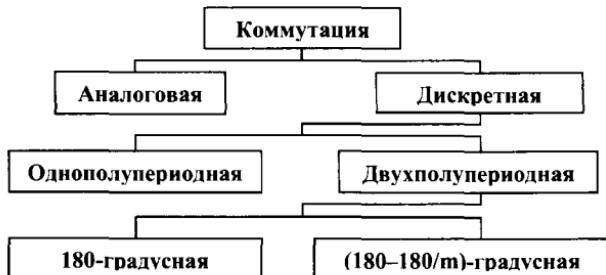
Рис. 1. Типы коммутации ВМАП
