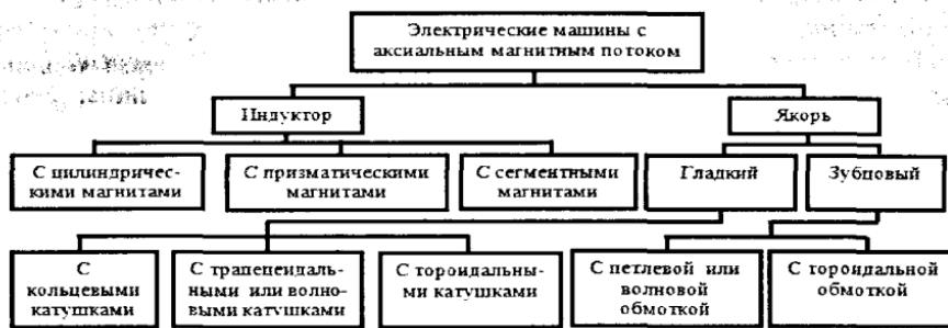
Рис. 8. Классификация конструктивных исполнений ВМАП
