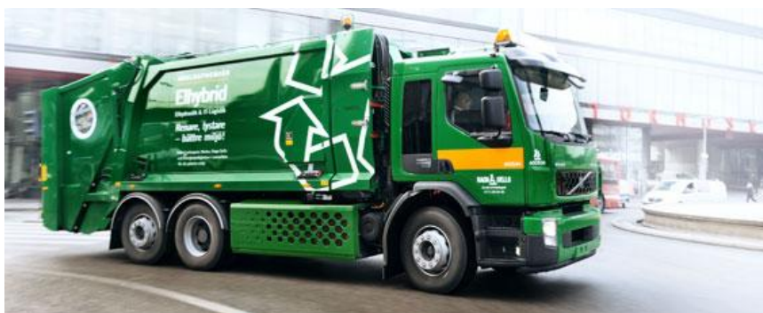
Рис. 4. Гибридный мусоровоз Volvo FE Hybrid
