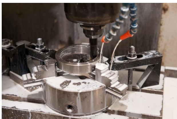
Рис. 2. Приспособление, заготовка и фреза в момент работы
