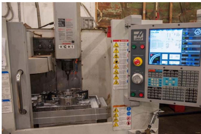
Рис. 1. Обработка резьбы фрезерованием на станке HAAS
