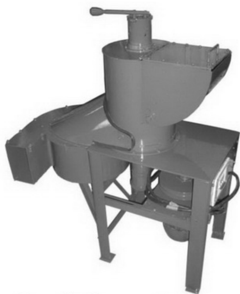
Рис. 13. Внешний вид измельчителя волокнистых материалов МКВ-0,1/0,3М
