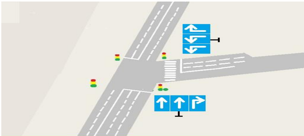
Рис. 5. Перекрёсток Тургоякского шоссе и улицы Севастопольской после доработки
