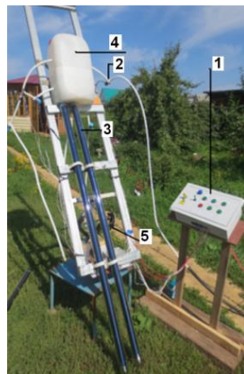
Рис. 4. Общий вид установки: 1 – шкаф управления; 2 – электромагнитные клапаны; 3 – трубки солнечного коллектора; 4 – опреснитель; 5 – электрический привод
