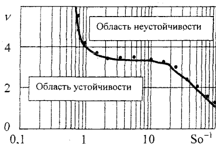
Рис. 4. Диаграмма устойчивости цапф симметричного ротора на подшипниках с кольцевой канавкой:
