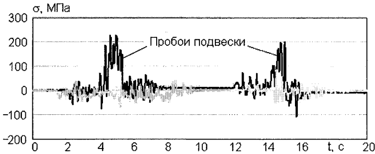
Рис. 4. Процессы изменения напряжений в опасных зонах корпуса бортовых фрикционов при наезде и съезде с одиночной неровности: — наезд на неровность одной гусеницей; ..... наезд на неровность двумя гусеницами одновременно
