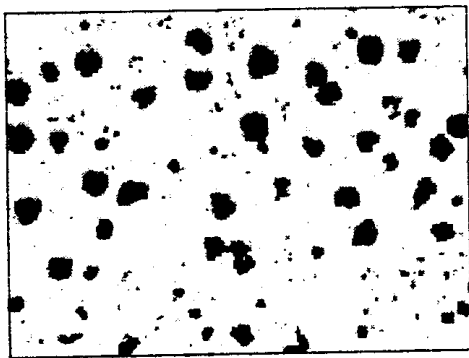
Рис.1. Структура графита. Увеличение \times 100 :
