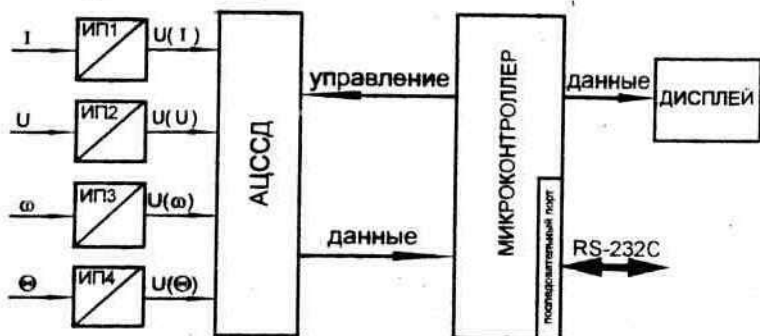
Рис.1. Структурная схема микропроцессорного измерителя вращающего момента
