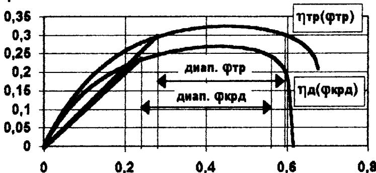
Рис.3 Соотношение тяговых характеристик БА при копании и транспортировании. Грунт III кат ( $c=9\dots 12$ )
