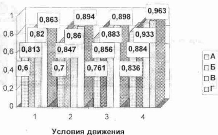
Рис. 5. Гистограмма показателя проходимости автомобиля УАЗ-3151 в различных условиях движения
