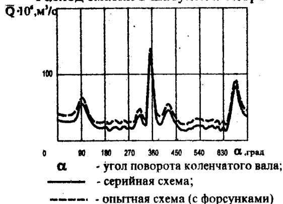
Рис.3. Снижение потерь в смазочной системе двигателя ЧН 15/20,5
