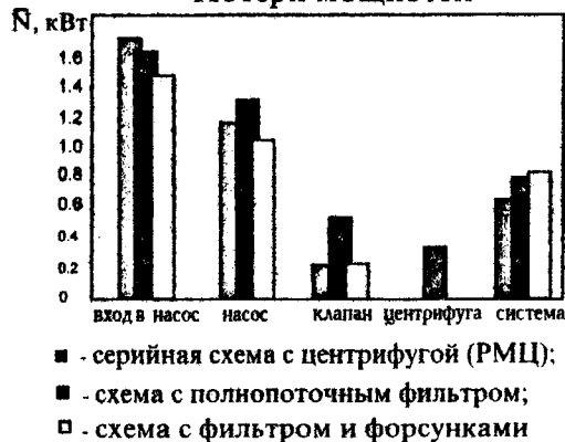
Рис.3. Снижение потерь в смазочной системе двигателя ЧН 15/20,5
